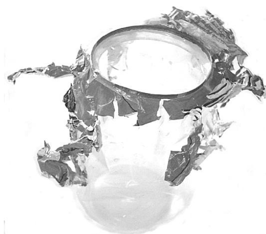
Abbildung 65: Die Innenschicht aus Epoxidharz bleibt vollständig erhalten, wenn der metallische Anteil einer Coca-Cola-Getränkedose mit 18%iger Salzsäure aufgelöst wird. Der Außenlack hingegen hält dem Auflösungsprozess, welcher unter Gasentwicklung verläuft nicht stand.
