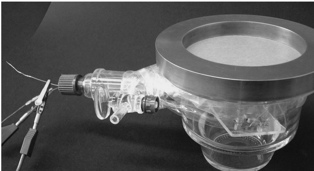
Abb. 35: Umgebauter Exsikkator als Messapparatur zur Ermittlung der Sauerstoffdurchlässigkeit von Prüffolien. An Stelle des Glasdeckels wird der Messingring auf die Prüffolie gelegt. Im Inneren befindet sich die Plexiglasplatte mit Knopfzelle und 80\ \Omega –Widerstand. Der Spannungsabgriff an den beiden Drähten erfolgt mit Hilfe von Krokodilklemmen
