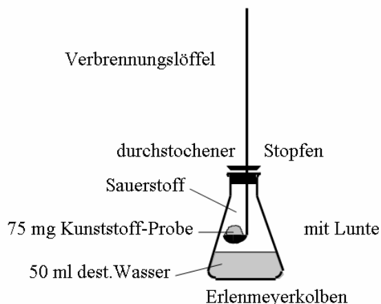
Abbildung 66: Apparatur zur Bestimmung von Chlor in organischen Verbindungen [149, S. 13, 44], [150, S. 94-98]
